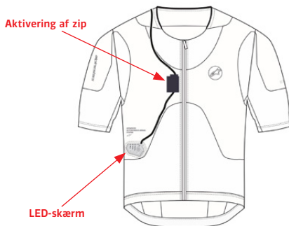
Figur 25: Fjernelse af LED-displayet (3) og aktiveringslynlåsen (2)
