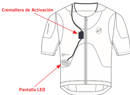
Figura 25: Extraer la Pantalla LED (3) y el Cierre de Activación (2)
