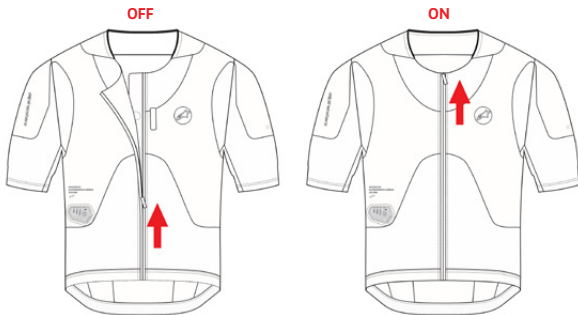
그림 8: 활성화 지퍼(2) 닫힘 시 시스템 켜짐
