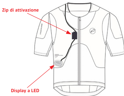
Figura 25: Rimozione del display a LED (3) e della zip di attivazione (2)
