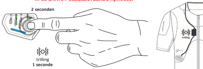
Figuur 10: Druk de displayknop (3a) 2 seconden in om de rijmodus te wijzigen.
