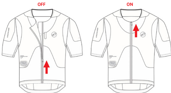
Figura 8: Il sistema si accende quando viene chiusa la zip di attivazione (2)
