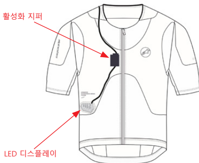
그림 25: LED 디스플레이(3) 및 활성화 지퍼(2) 분리
